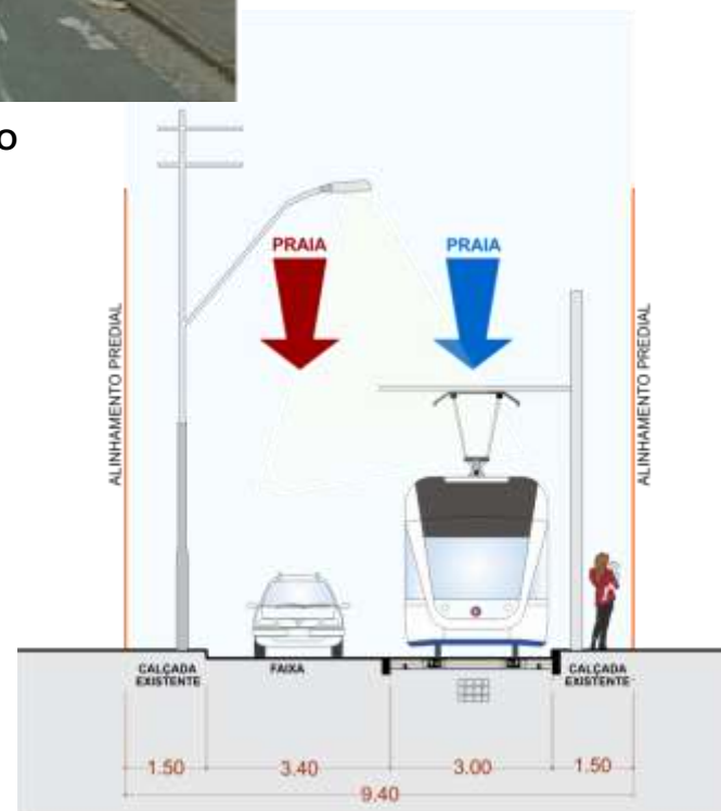
SEÇÃO TRANSVERSAL FUTURA – RUA CONSTITUIÇÃO
