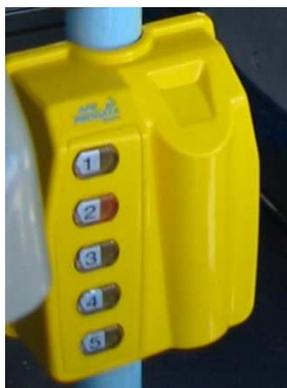
O teclado de seccionamento tarifário (ou seletor tarifário) é o equipamento que permite a cobrança de diferentes tarifas, nas linhas que possuem seccionamento tarifário, de acordo com as seções de origem e destino dos passageiros.
