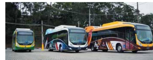
Um ônibus protótipo começou sua operação regular em dezembro de 2010. Durante o ano de 2015 começou a funcionar a Estação de Produção e Abastecimento de Hidrogênio, em São Bernardo do Campo/SP, e no mês de junho mais três ônibus passaram a ser operados no corredor, com inovações em relação ao protótipo como a nacionalização de todo o sistema de tração, maior capacidade de carregamento de passageiros e aperfeiçoamento dos sistemas de controle.
