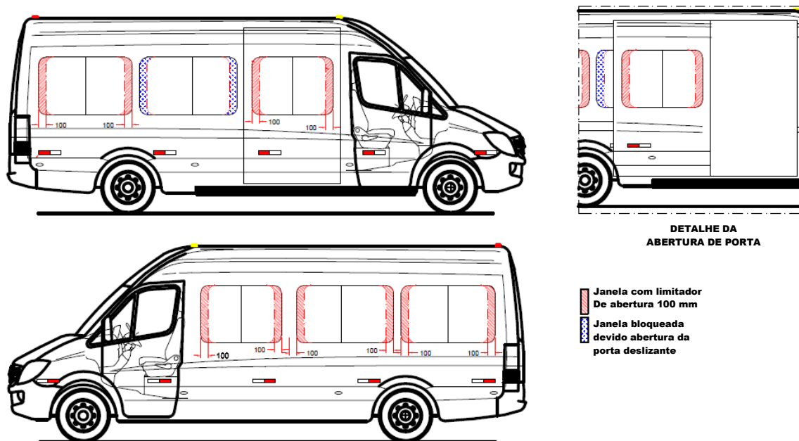
Figura 2 – Janelas com limitador e janela bloqueada
