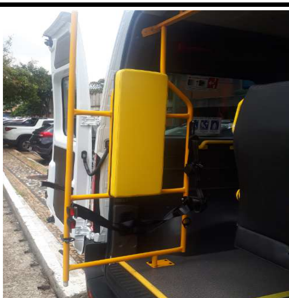
Guarda corpo na traseira do veículo com sistema de abertura móvel para permitir a saída dos passageiros
