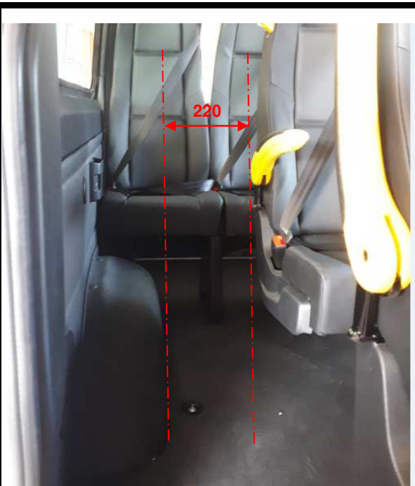
Poltrona posicionada ao lado da caixa de rodas o espaçamento mínimo resultante no corredor deve ser 220 mm
