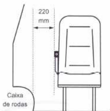
Figura 15 - Espaçamento entre poltrona e caixa de rodas
