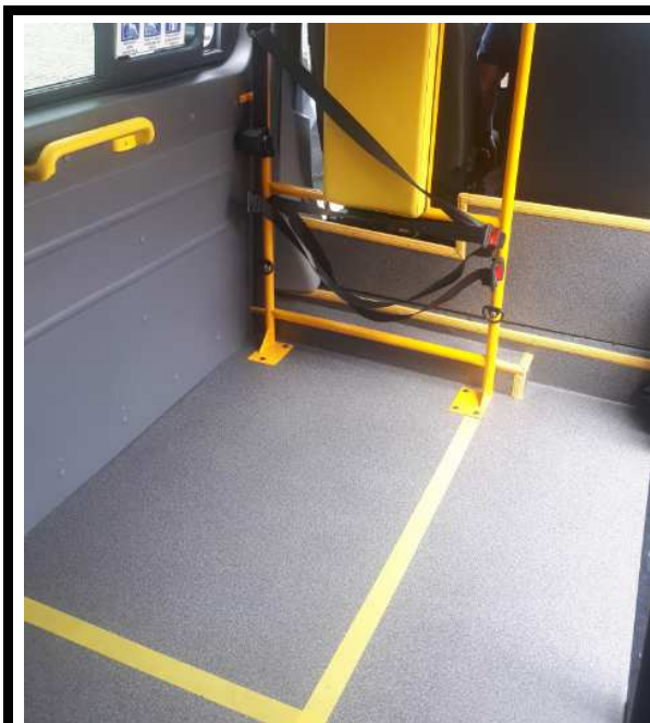
As áreas reservadas devem estar demarcadas no piso com faixa entre 40 mm e 50 mm
