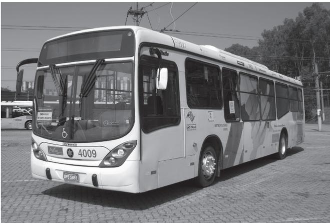
**Figura 5. Ônibus movido a etanol**
